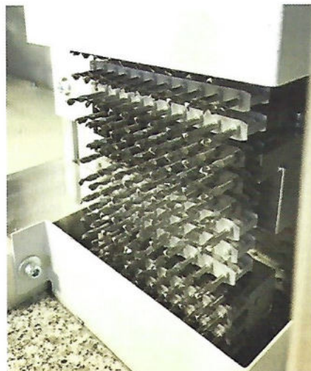
Vollautomatisierter Werkzeugwechsel. Die in der DRB 610 1+1 AL integrierten Euromagazine fassen in Summe bis zu 2.600 Werkzeuge
