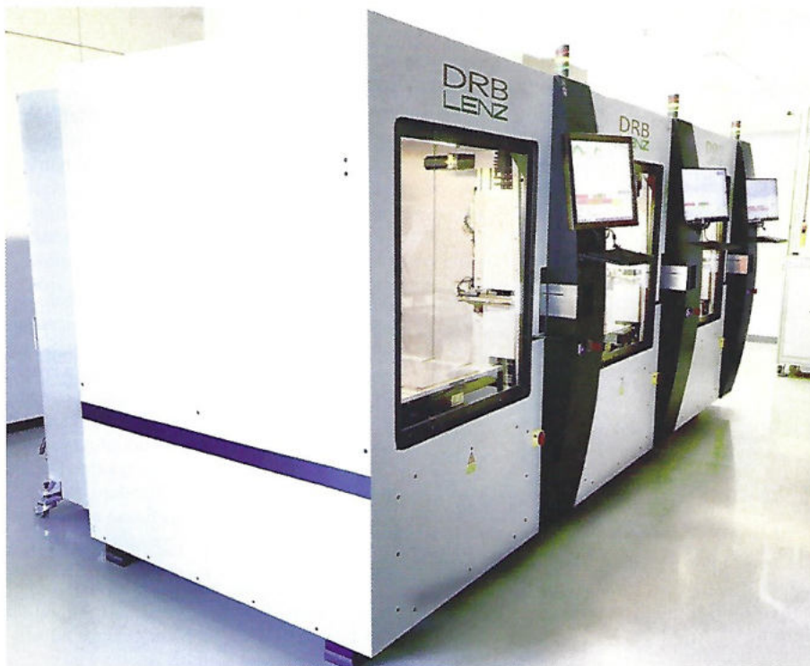
Modernisierungsprojekt: Weitere Bohr- und Frässysteme DRB 610 1+1 AL der Ernst Lenz Maschinenbau GmbH wurden in die Fertigung der Becker & Müller Schaltungsdruck GmbH integriert
