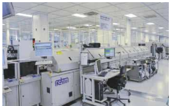
Die Kühlstrecke der Reflowöfen wurde von 4 auf 6 Zonen erweitert
