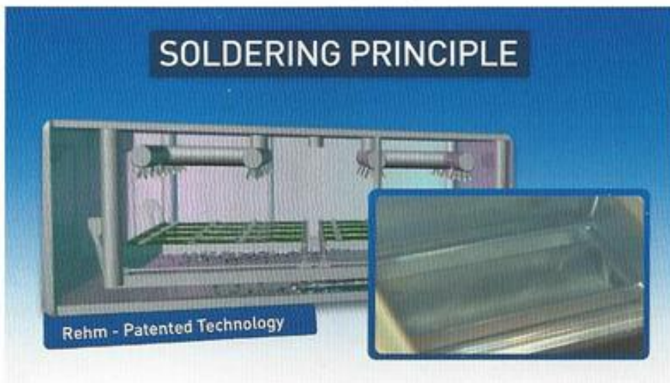
Abb. 3: Prozesskammer der Condenso X zum Löten bei ruhender Baugruppe mit Vakuum
