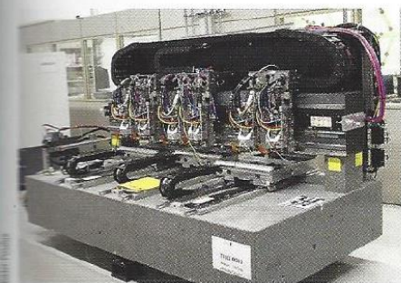
Ausgestattet mit zwei Arbeitsköpfen verfügt jede Station über zwei verschiedene hochpräzise Spindeln. Die Aufteilung der Spindeltypen auf die Bohrköpfe ist frei wählbar.
